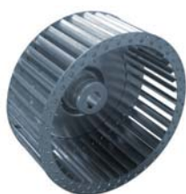
Laufblätter statisch und dynamisch ausgewuchtet, gemäß ISO 1940
